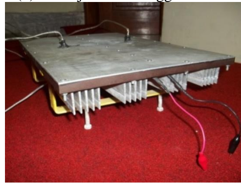
Gambar 5(a) Struktur dalam sel TE (b) Modul TE 32 sel
