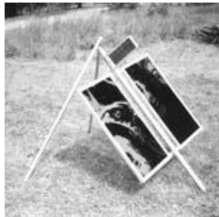
Gambar 1. Mekanisme aktif solar tracker (Poulek dan Libra, 1998; 2000(a); 2000(b))
