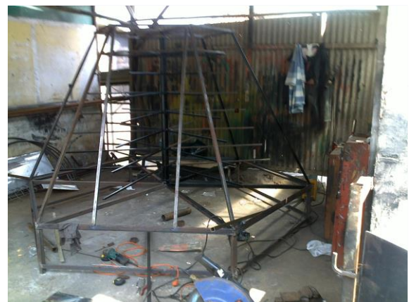
Gambar 1 Pembuatan Rangka Pengering Hibrida (dibuat 7 rak)
