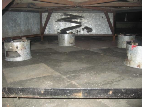
Gambar 4 Tungku Biomasa/Arang Diletakkan Dibawah Pelat Dasar
