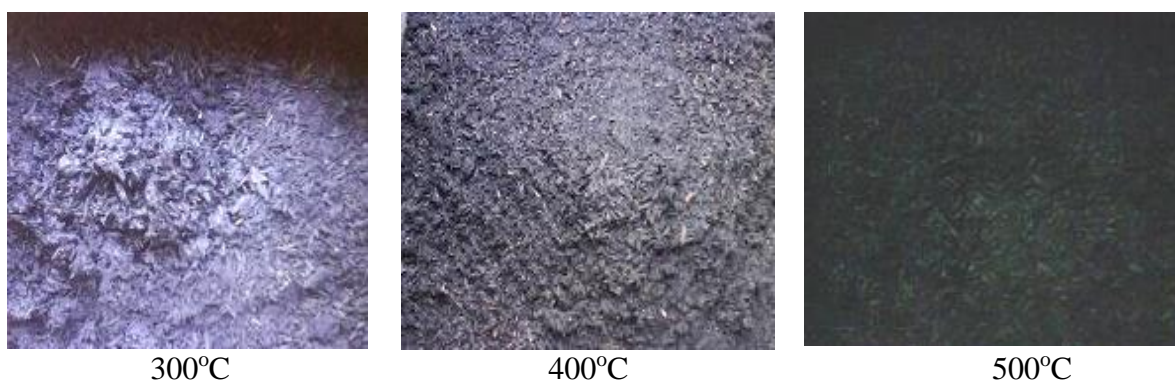
Gambar 5. Padatan hasil pirolisis sekam padi pada kapasitas 5 kg/jam, kadar air 20,7%.
