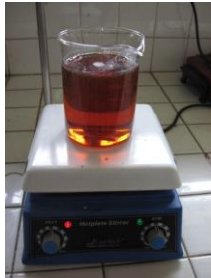
Gambar. 2 Pencampuran minyak kapuk randu dengan sodium metoksid
