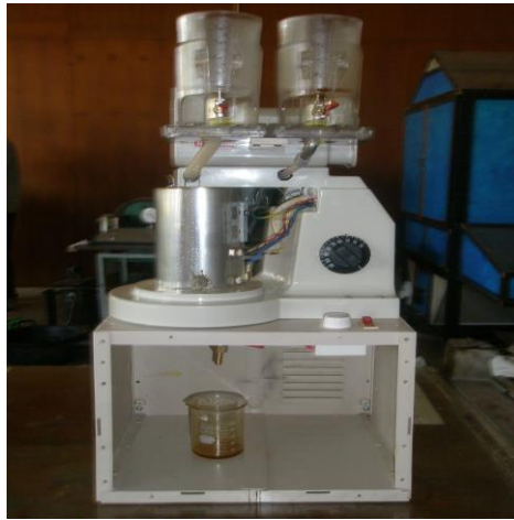
Gambar 3. Rangkaian alat bioreaktor hidrolisis enzimatis
